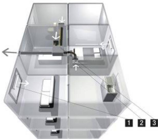
Предлагая переменный расход воздуха, адаптированный к потребностям помещений, регулируемое вентиляционное оборудование AEREKO уменьшает теплопотери, обеспечивает хорошее качество воздуха и предотвращает появление конденсата на стеклах и плесени на стенах. Разработанная компанией AEREKO гигрорегулируемая вентиляция является на сегодняшний день одной из передовых технологий в области регулируемой вентиляции.
